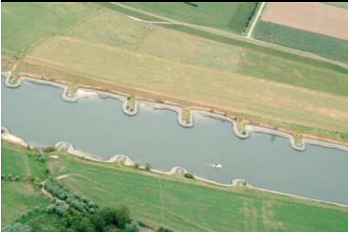
Van de Rijntakken zijn de oevers van de IJssel het zwaarst 'genormaliseerd'. Zij zijn vrijwel geheel in steen gezet waardoor de IJssel geen kant meer op kan. Rivierprocessen als erosie en sedimentatie spelen hier nog nauwelijks een rol.
