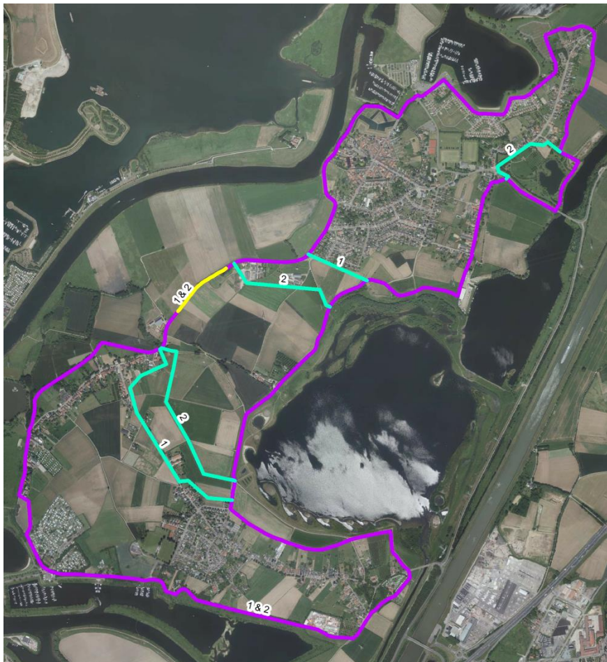
Figuur 5: Variante 1 en 2 in retentiegebied bij dijkkring 81. De locatie van de instroomdrempel is gelijk.
