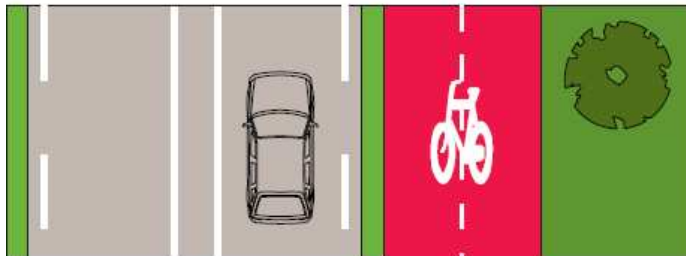
GOW 80 km/h, vrijliggende fietspaden (in het voorbeeld twee-richtingsfietspad aan één zijde)
